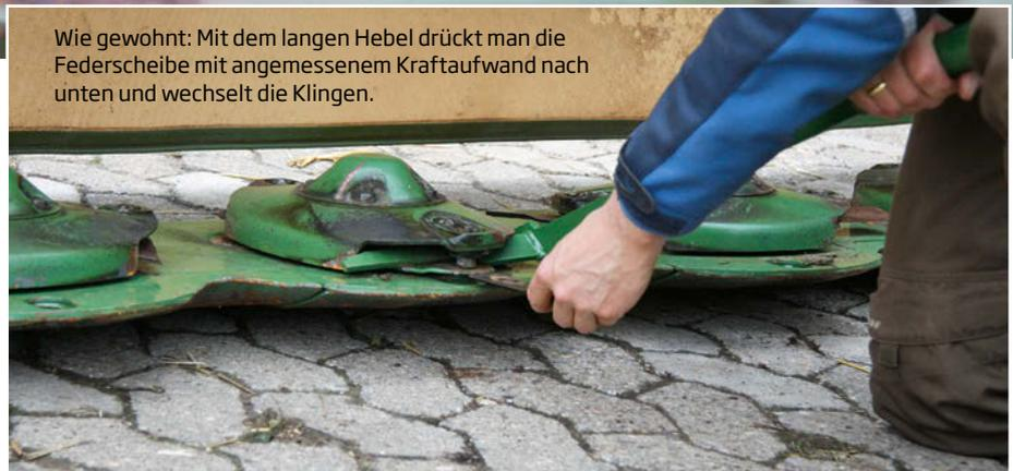
Wie gewohnt: Mit dem langen Hebel drückt man die Federscheibe mit angemessenem Kraftaufwand nach unten und wechselt die Klingen.
