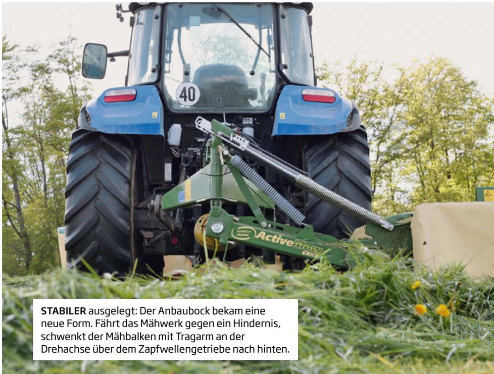
**STABILER** ausgelegt: Der Anbaubock bekam eine neue Form. Fährt das Mähwerk gegen ein Hindernis, schwenkt der Mähbalken mit Tragarm an der Drehachse über dem Zapfwellengetriebe nach hinten.
